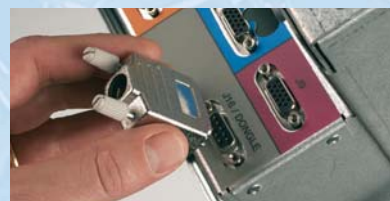
Enkel mjukvaruuppdatering via en unik löstagbar minneskapsel, ingen programmering eller dataförlust.
